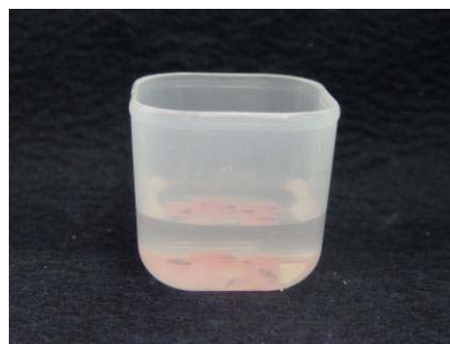
Fig. 6– Imersão - água destilada à 37^\circ\text{C} por 16 horas
