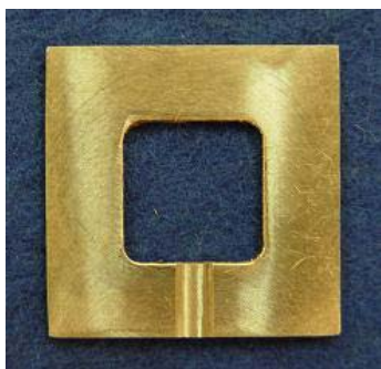
Fig. 1– Matriz metálica (12x12x1 mm)
